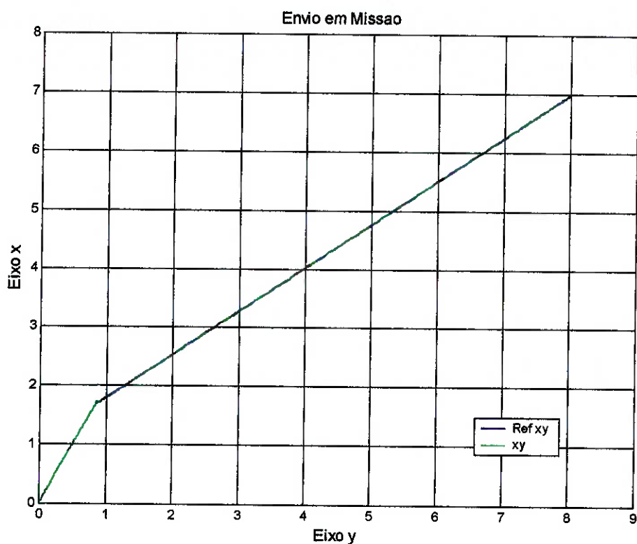
Figura 11.7 - Referência e resposta de posições lineares em função do tempo em missão (oito propulsores e compensação de correnteza)
